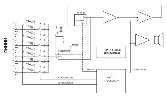
В состав блока входят плата коммутации (с выходными реле), плата кнопок и индикации и плата процессора. К каждой линии связи подключен балластный резистор, который определяет уровень тока через АУ. При работе микрофона АУ, на нем выделяется звуковое напряжение.
