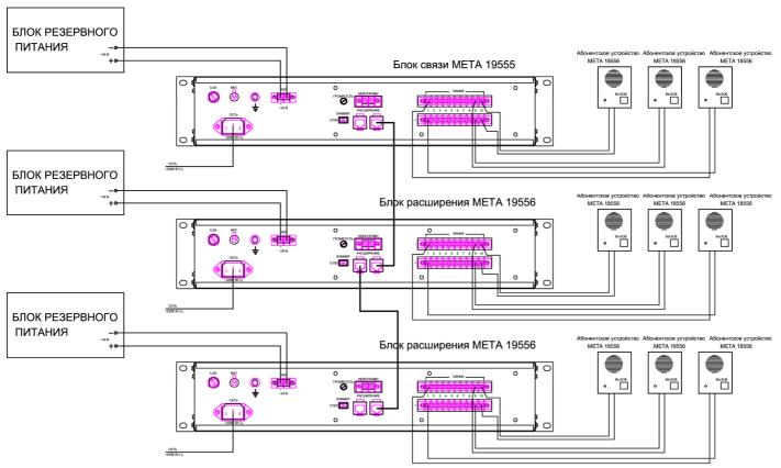
Блоки связи и расширения соединяются между собой кабелями, входящими в комплект блока расширения. Блоки БРП подключаются проводами сечением не менее  $0.5~{\rm km}^2$
