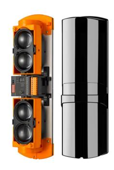
Активный уличный инфракрасный датчик ST-SA254BD-MC предназначен для обнаружения пересечения невидимого ИК-барьера, создаваемого между передатчиком и приемником. Устройство может использоваться для защиты внешних и внутренних рубежей и отлично подходит для охраны объектов, периметр которых имеет значительную протяженность.
