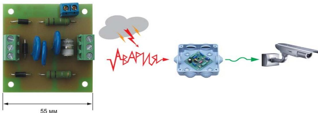
«АЛЬБАТРОС-12/70» предназначен для **защиты от кратковременного или длительного перенапряжения**, вызванного наводками в результате воздействия электромагнитных импульсов (грозовые разряды, коммутационные помехи и др.) и авариями в цепи электропитания приборов. Блок рассчитан на использование в цепях питания номинальным напряжением 12 В постоянного тока. Обеспечивает защиту от высоковольтных импульсов амплитудой до 10 кВ.
