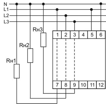
Рис. 1. Схема подключения при измерении тока до 20 А.
