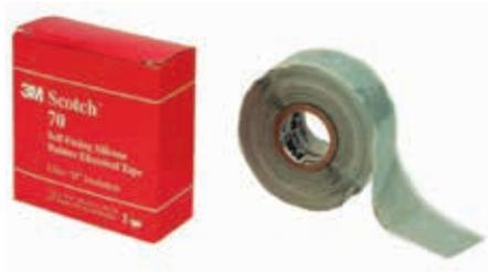
Самовулканизирующаяся температууроустойчивая силиконовая лента для изоляции кабельных наконечников. Диапазон рабочих температур от - 60 до + 180°C. Лента устойчива к трекингу и электрической дуге. Сохраняет эластичность в течение длительного времени. Обладает высокой электрической прочностью.
