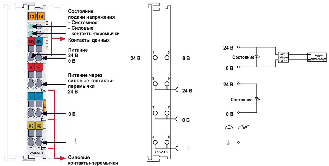
Модуль электропитания внутренней системы увеличивает подачу тока для внутренней системы 5 В пост. тока на 2 А.
