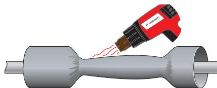
**5.4.2.** Надвинуть на муфту внешний защитный кожух, расположив его симметрично относительно центра муфты и произвести усадку от его середины.
