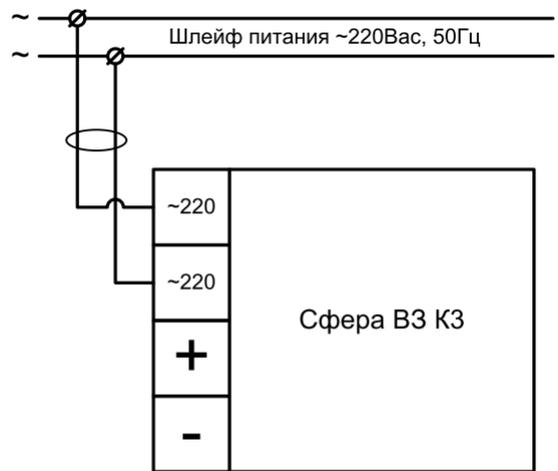
Схема подключения оповещателя
