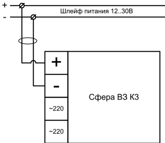
Схема подключения оповещателя
