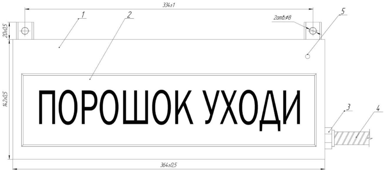
1-корпус, 2- прозрачное окно, 3- кабельный ввод, 4- металлорукав, 5- светодиод "сеть"
