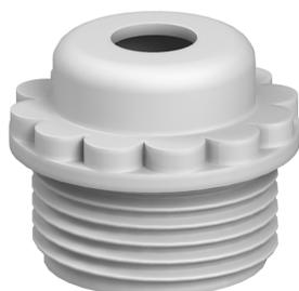
С открытым кабельным вводом. Уплотнение для ввода в резьбу Pg согласно IEC 423. На конце резьбы расположен самоуплотняющийся конус, поэтому не требуется уплотнения соединительной резьбы. Степень защиты IP54.
