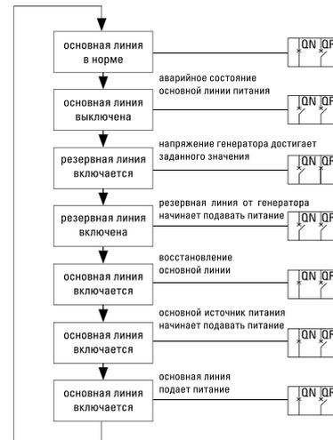
T1 – время задержки передачи. Контроллер можно настроить 0с – 180 с при аварийной ситуации с основным источником питания, время перед разрывом (разъединением) QN;
