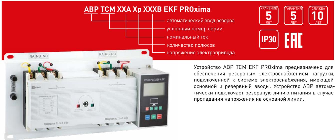
Устройство АВР ТСМ EKF PROxima предназначено для обеспечения резервным электроснабжением нагрузки, подключенной к системе электроснабжения, имеющей основной и резервный вводы. Устройство АВР автоматически подключает резервную линию питания в случае пропадания напряжения на основной линии.
