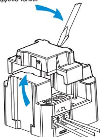
4. Снимите переднюю крышку с регулирующего модуля
