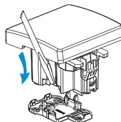
2. Снимите заднюю крышку кнопки арт. 27659.
