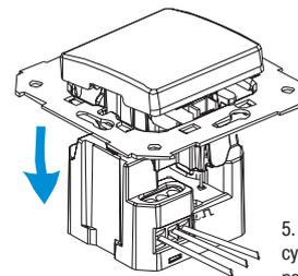
5. Установите механизм с суппортом на механизм регулятора с усилием для хорошего соединения
