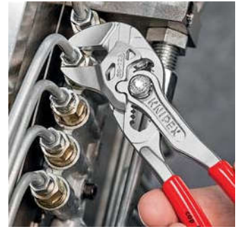
Переставные мини-клещи для точной механики
